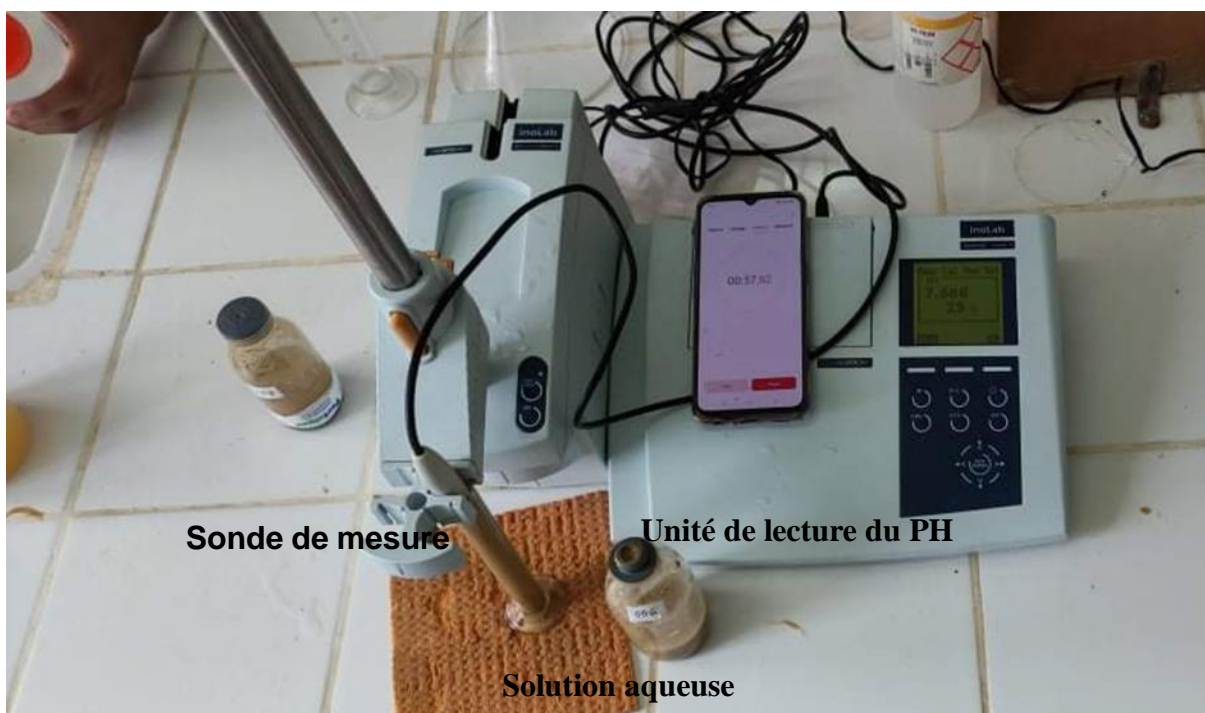
Figure 08 : Illustration de la mesure du pH de la solution du sol.
