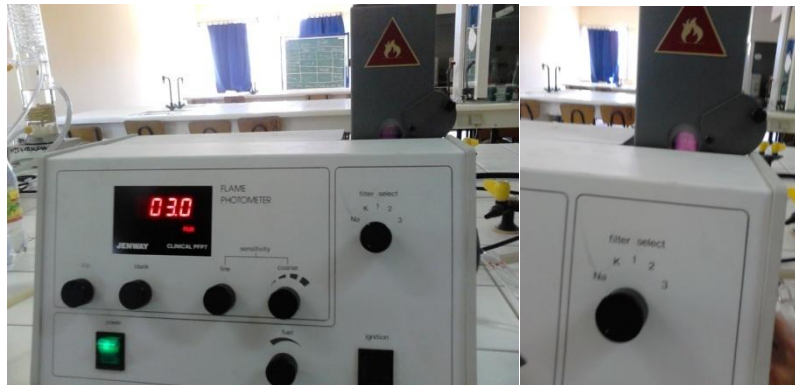
Figure 6 : Aspiration de la solution standard de potassium à 3 mg/l et la flamme violette caractéristique du potassium.
