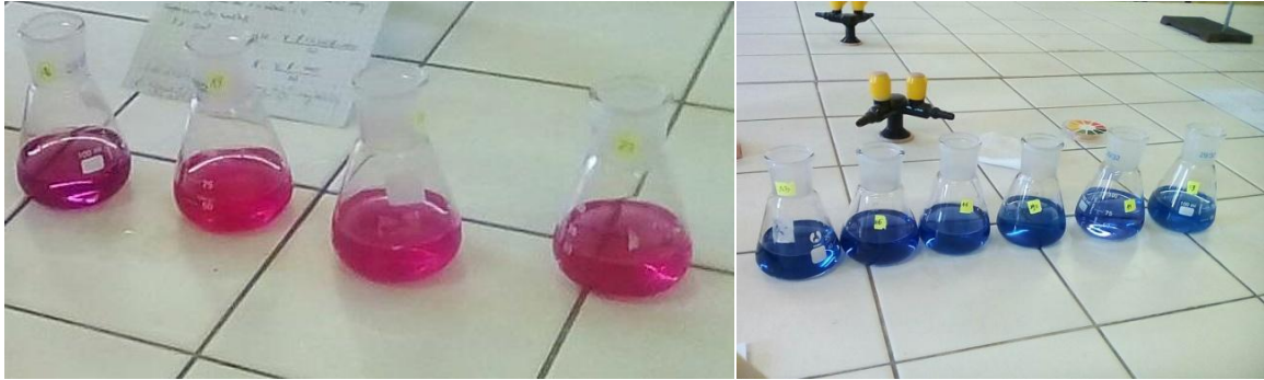
Figure 10 : Virage de l'indicateur coloré lors du dosage de la dureté calcique par une solution d'EDTA.
