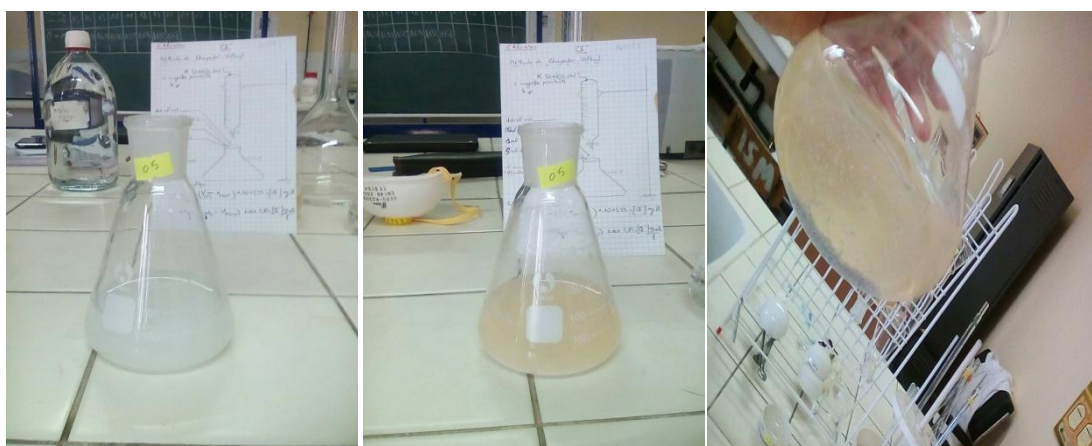
Figure 13 : Changement de coloration de l'échantillon analysé lors du dosage des chlorures.
