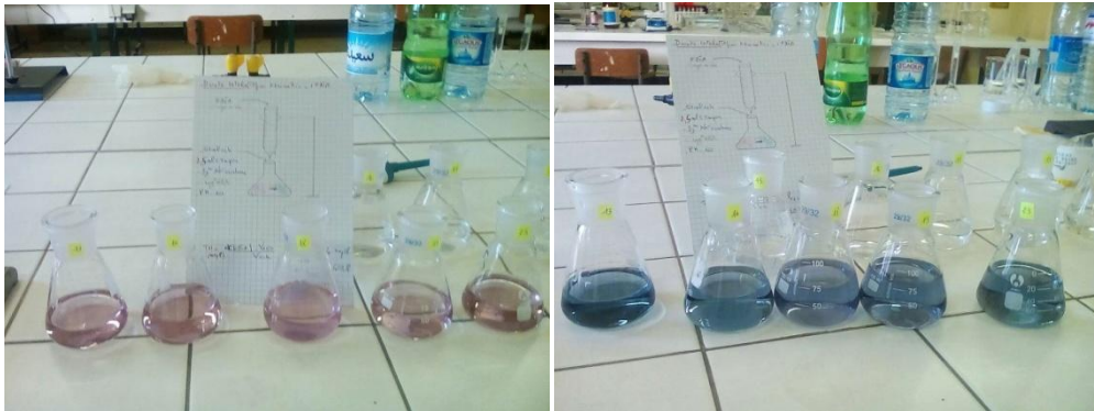
Figure 9 : Virage de l'indicateur coloré lors du dosage de la dureté.
