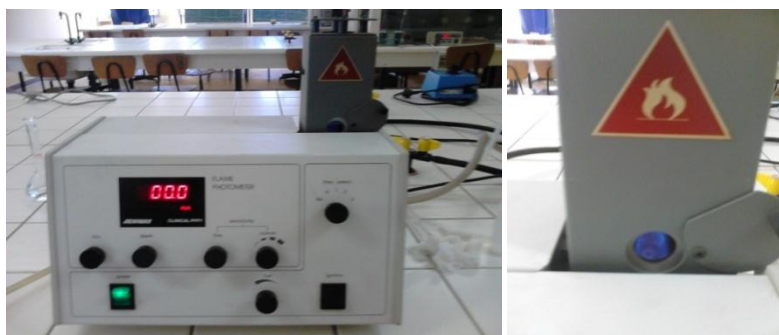
Figure 5: Réglage du zéro du photomètre de flamme et la flamme bleue obtenue en aspirant le blanc.
