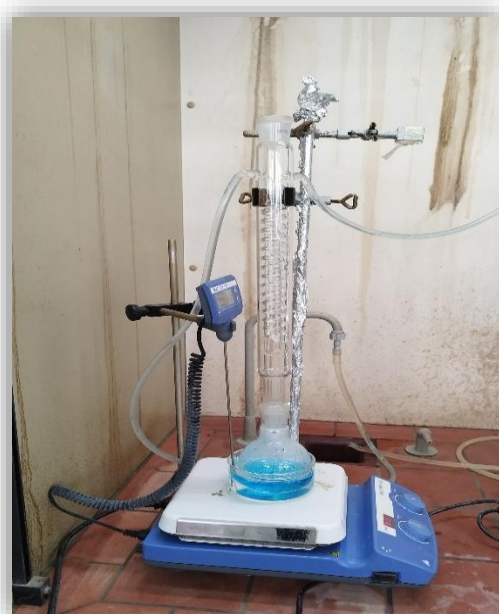
Figure II-1 : Montage expérimental utilisé pour la synthèse des nanoparticules
