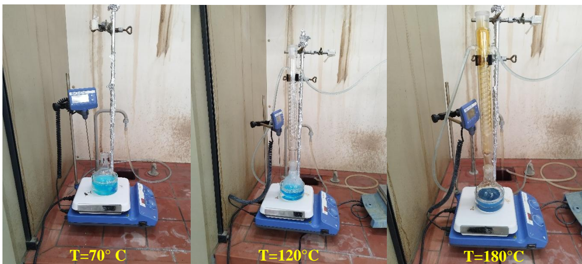
Figure II-2 : Évolution de la synthèse de l'oxyde cuivre par polyol à différentes températures
