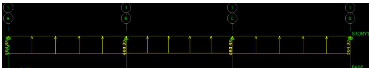
Diagramme des moments fléchissant de la nervure à l'ELS
