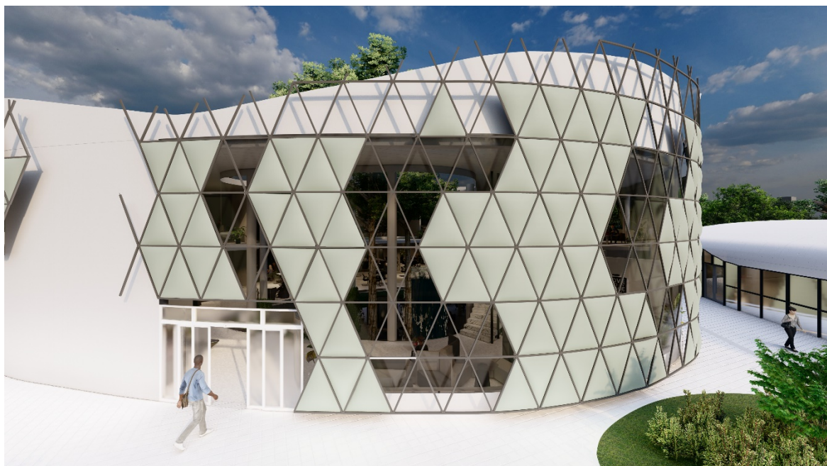
Figure 121: Façade en ETFE de l'entité innovation et développement. Source : Auteurs.
