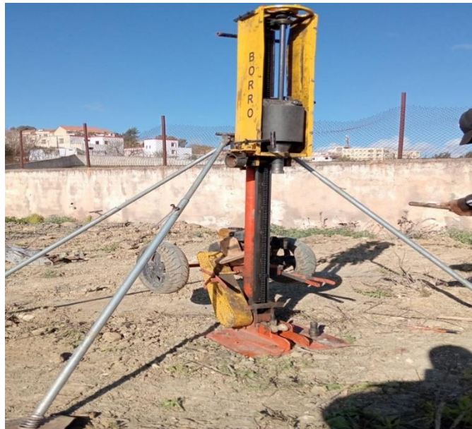
Figure 2-12 Dispositif au pénétromètre dynamique (Draa el Mizan 2025).
