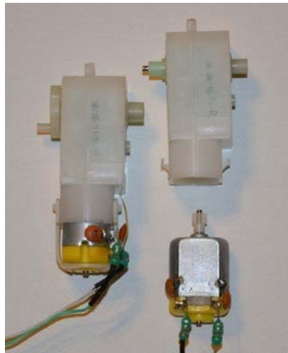
Figure III.12 : Moteur à engrenage
