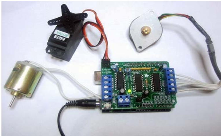
Figure III.2 : montage d'un Shield moteur avec différents moteurs.
