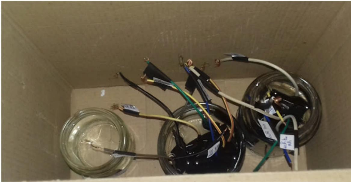
**Figure (III-7) :** Corrosion libre de l'aluminium dans une solution de NaCl
