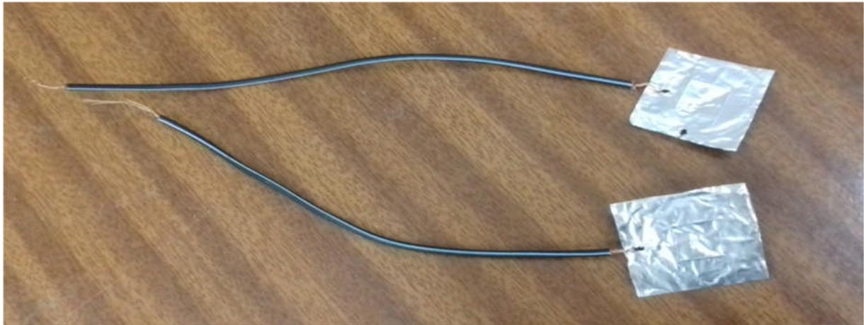
**Figure (III-3) :** Electrode pour test de corrosion obtenue à partir du papier aluminium d'emballage de médicaments
