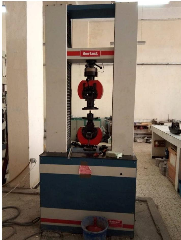
**Figure (III-14) :** Machine de traction de marque Ibertest
