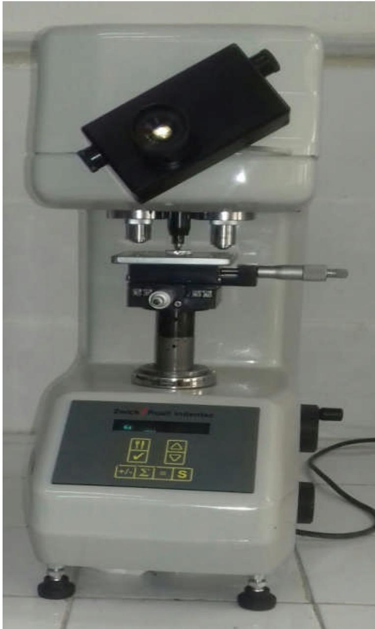
**Figure (III-10) :** Microduromètre de marque ZWICK Roell Indentec
