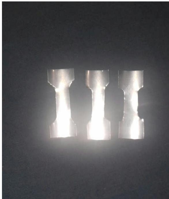
Figure (III-13) : Epreuves de traction utilisées
