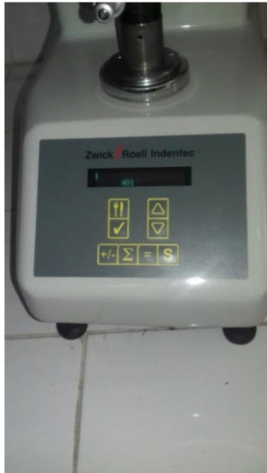
**Figure (III-11) :** l'Ecran affichant la microdureté HV
