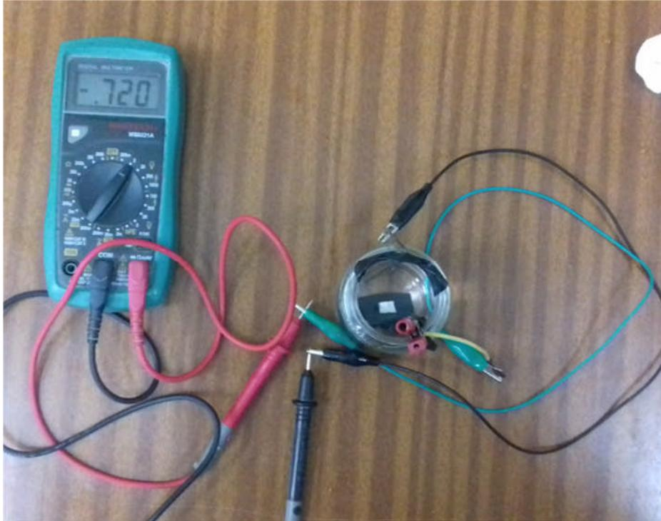
**Figure (III-8) :** Dispositif utilisé pour la mesure du potentiel de corrosion de l'aluminium dans une solution de NaCl
