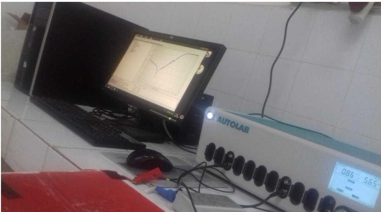
**Figure (III-9) :** Potentiostat de marque AUTOLAB
