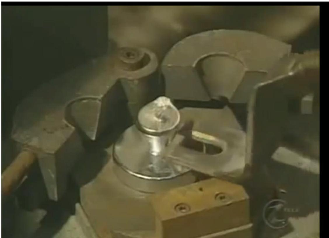
**Figure (I-3) :** Petit moule pour tester et vérifier l'alliage préparé [12]
