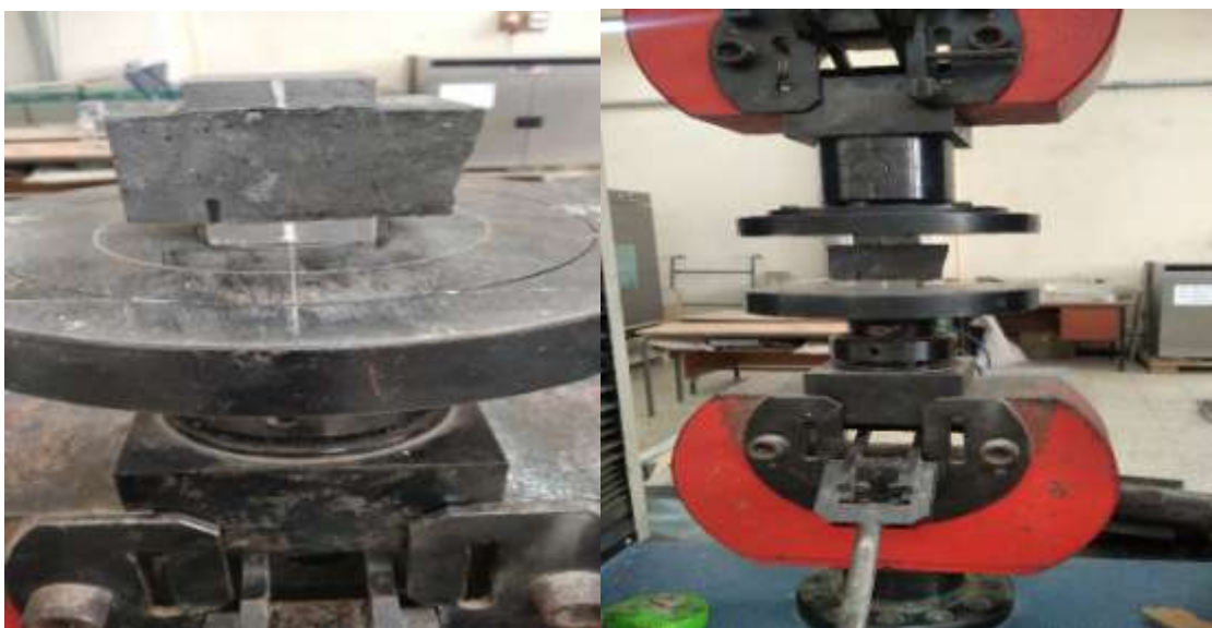
Figure II.14 : Dispositif de l'essai mécanique de compression
