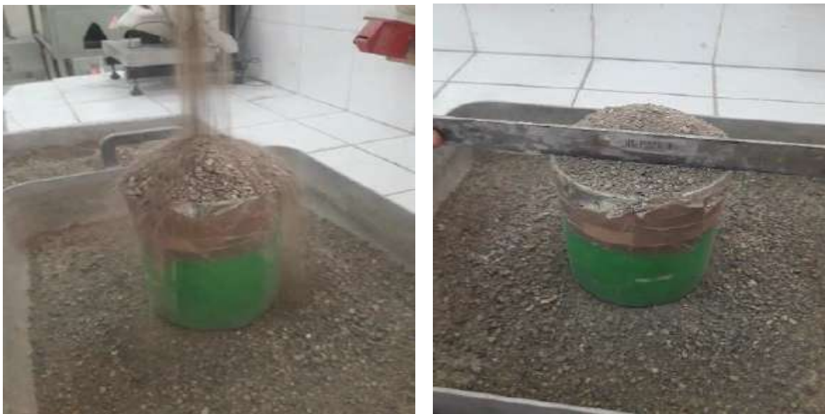
Figure II.5 : Essai de la détermination de la masse volumique apparente
