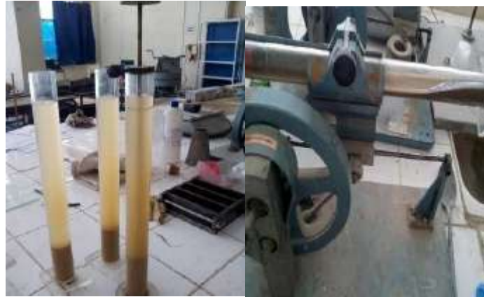
Figure II.7 : Principe de l'essai d'équivalent de sable
