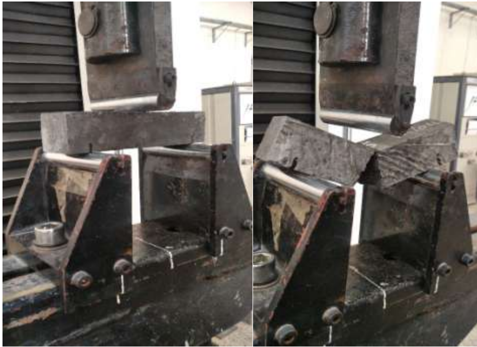
Figure II.13 : Eprouvettes de mortier : (a) Avant rupture, (b) Après rupture
