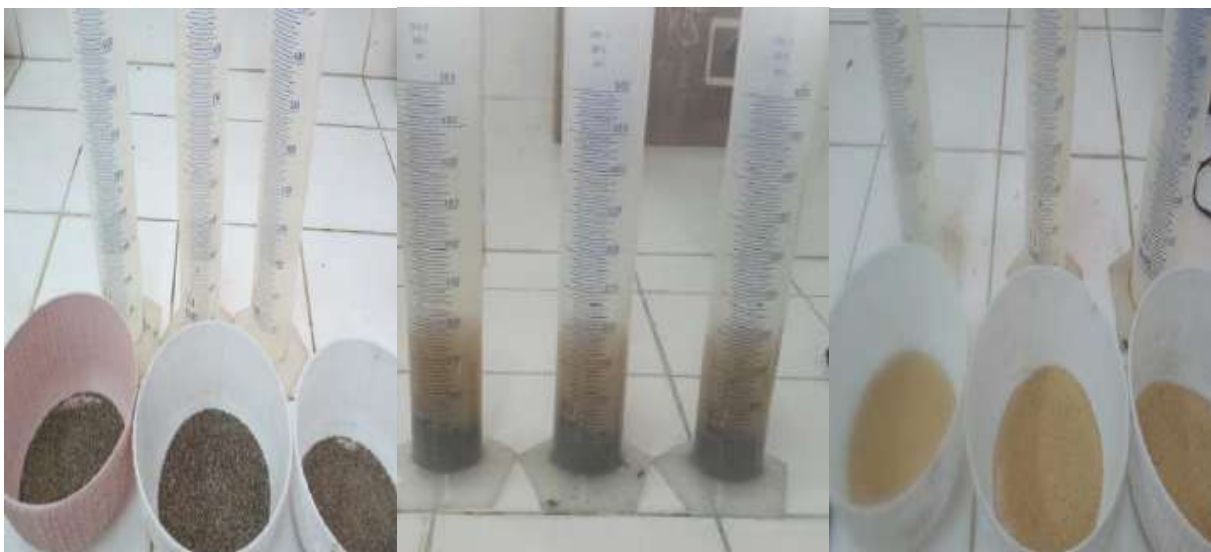
Figure II.6 : Essai de détermination de la masse volumique absolue
