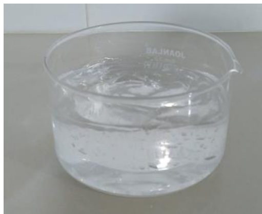
Figure 17 : Consistance de gel pour les formules 1, 2, 3, et 5
