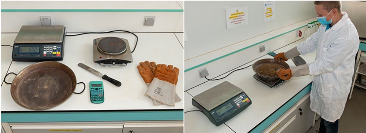
Figure III.6 : Essai de la teneur en eau
