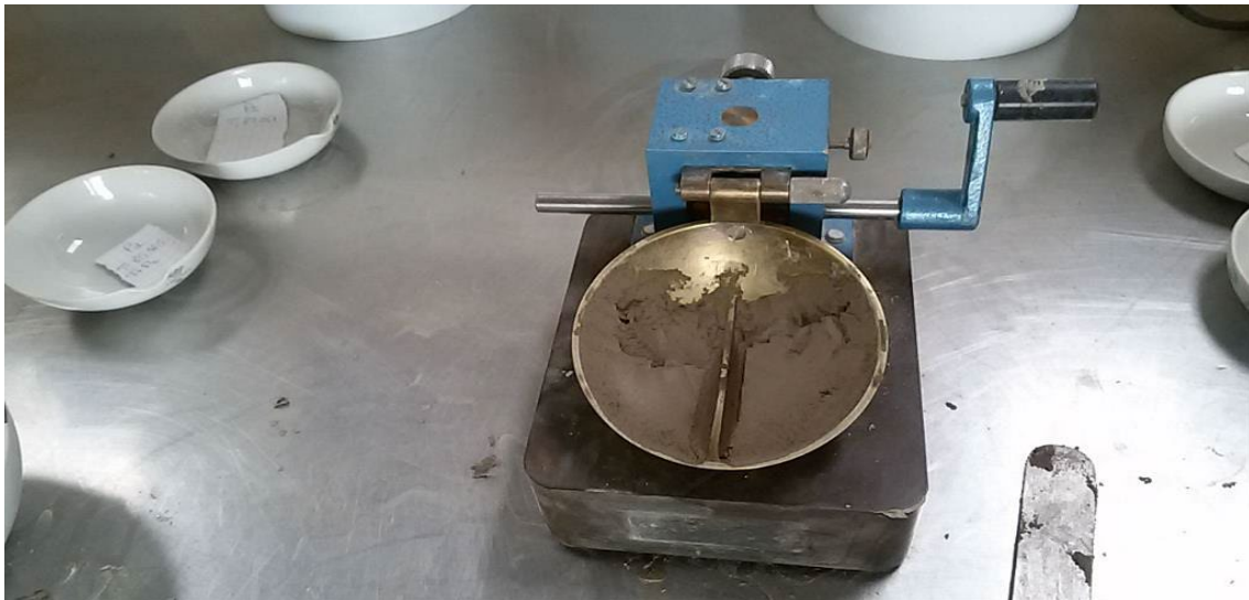
Figure III.7 : Essai de limites d'Atterberg
