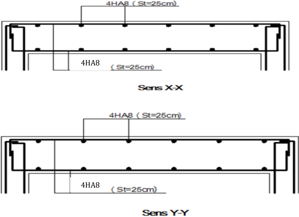
Figure III .2 : schéma du ferrailage de la dalle machine
