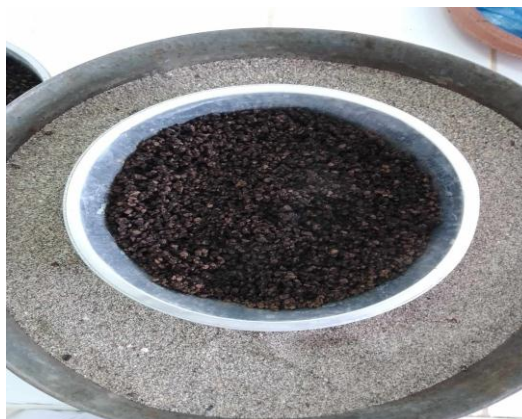
Figure 23 : traitement thermique du grignon ancien
