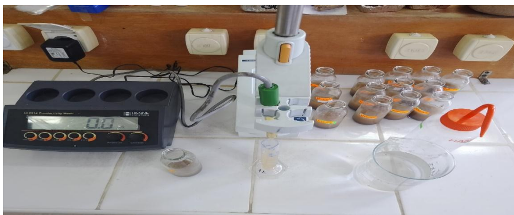
Figure 34 : illustration de la mesure de la conductivité électrique
