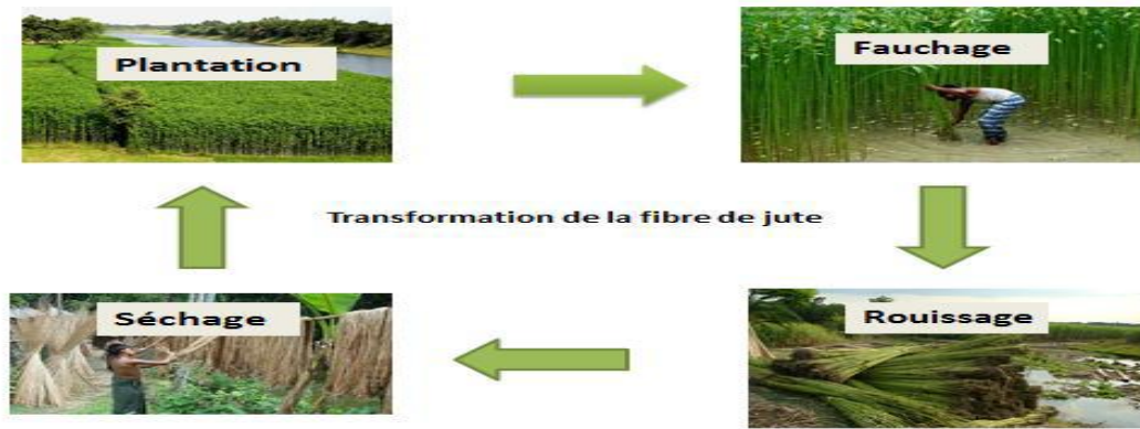
Figure I.13: Etapes extraction de la fibre de jute.
