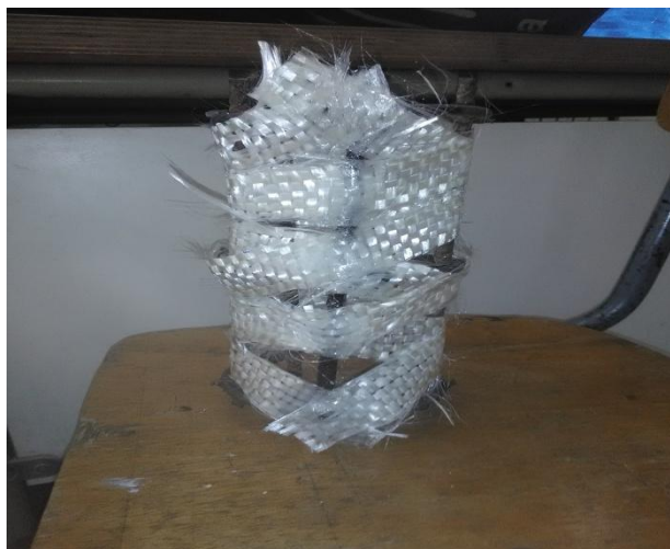
Figure II.10. Confinement en double hélice en fibres de verre.
