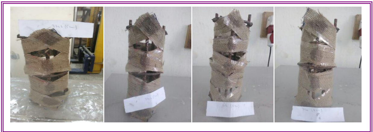
Figure II-09 : Collage du tissu sur le ferrailage
