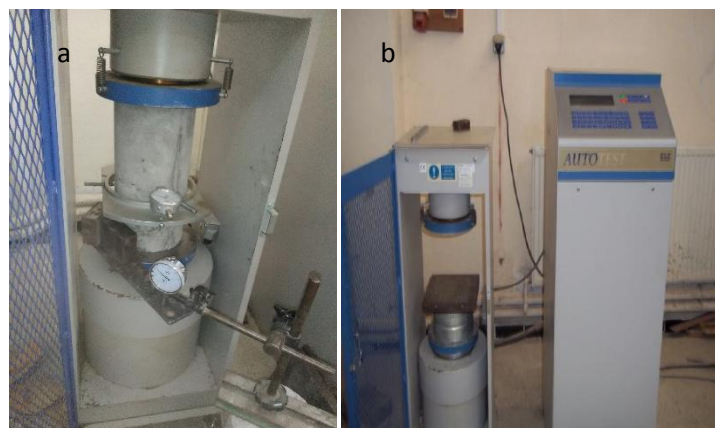
Figure II-15: Essai de compression sur éprouvette en béton avec confinement interne en fibre de Jute.
