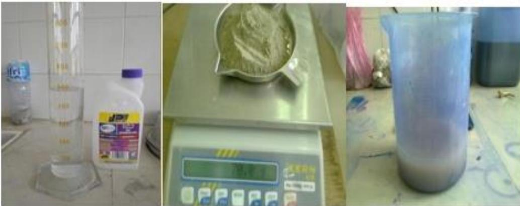
**Figure III.22**: Matériel d'essai au bleu de méthylène (résultats de l'essai à la tâche)
