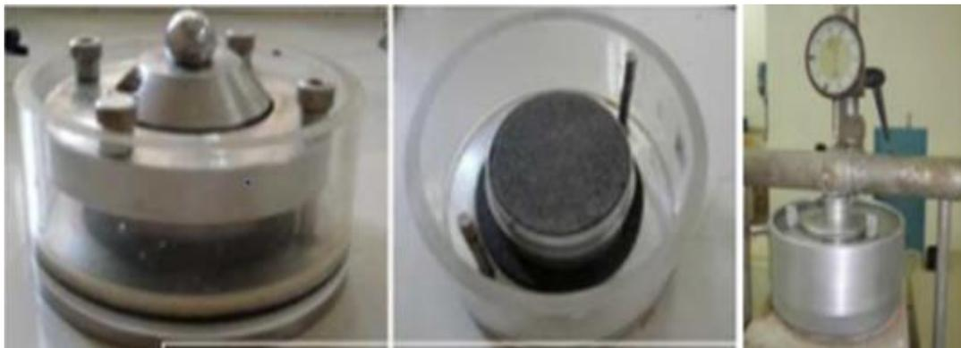
**Figure III.27.** Déroulement de l'essai œdométrique
