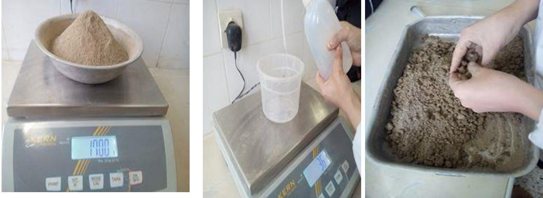
Figure III.24: Préparation de l'échantillon à l'optimum
