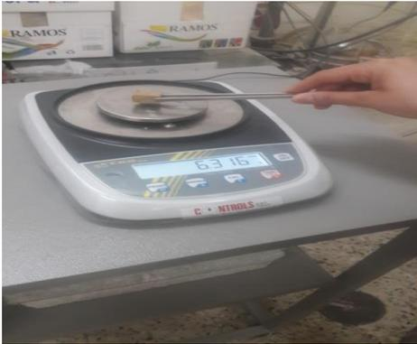
**Figure IV.19** : Peser l'échantillon après l'avoir essuyé avec du papier adsorbant
