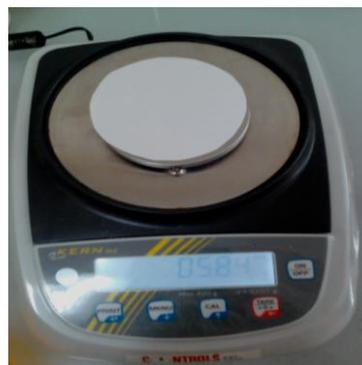
**Figure IV.4:** Détermination du poids du papier filtre
