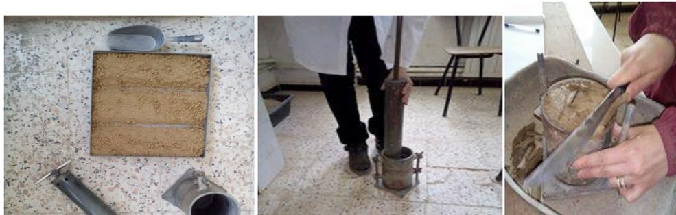
Figure III.25: Déroulement de compactage de l'argile.
