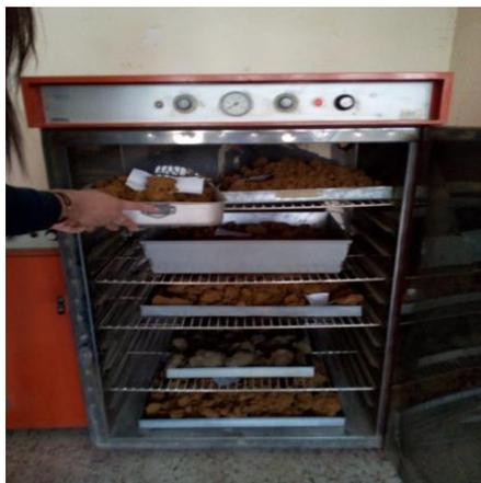
Figure .III .2 Séchage dans une étuve
