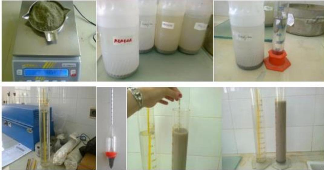
**Figure III.10.** Déroulement de l'essai analyse granulométrique par sédimentation
