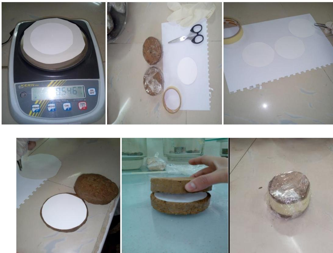
**Figure. IV.2.**préparation de l'échantillon de la succion matricielle (sandwich)
