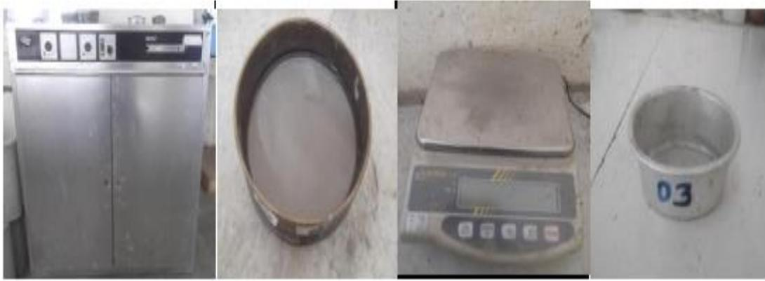
**Figure III.5.** Matériels utilisés dans l'analyse granulométrique par tamisage
