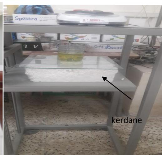
**Figure IV.18** : Pesée hydrostatique des échantillons
