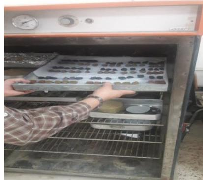
**Figure IV.20** : Etuvage des échantillons (105°C).
