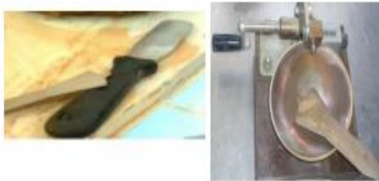
**Figure III.16.** L'appareil de Casagrand
