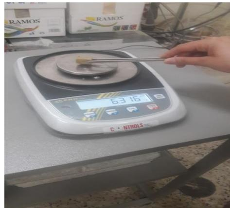
**Figure IV.16**: on pèse l'échantillon humide (après extraction des dessiccateurs)
