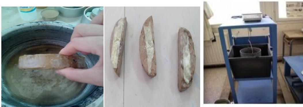
**Figure .III .12:** Déroulement de l'essai de la pesée hydrostatique.
