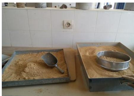
Figure .III.4 Passer dans le tamis 3.15mm
