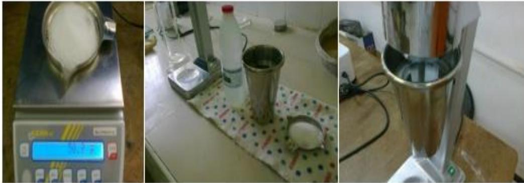
**Figure .III.9.** Préparation de la solution du défloculant.
