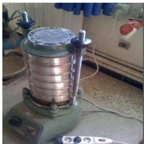
**Figure.III.6.** Matériels d'analyse manipulation du Granulométrie
