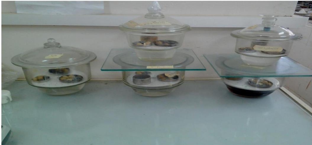
**Figure VI.8.** Mise en œuvre de la méthode des solutions salines saturées.
