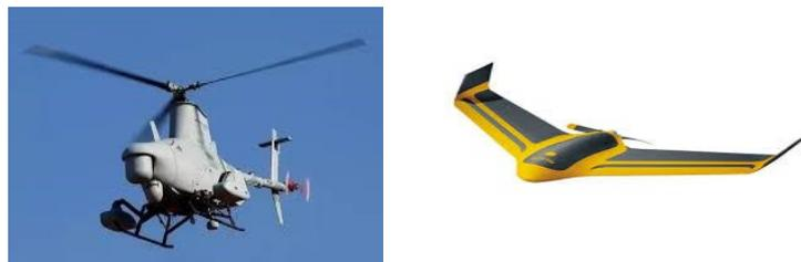
*Figure I-2: Drone à voilure tournante (à gauche) et, à voilure fixe (à droite).*
