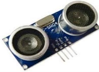
*Figure I-20 : Capteur télémétrique ultrason pour mesurer la distance avec un objet distant.*
