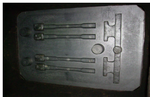
Figure II.1.3 - empreintes supérieure et inférieure du moule en sable
