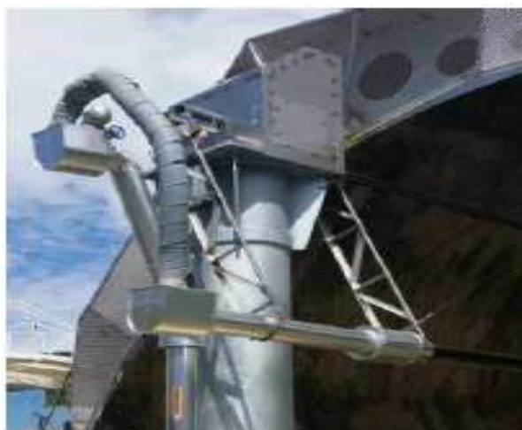
Figure III.6 : Schéma simplifié du mécanisme de poursuite du collecteur cylindro-parabolique de la MicroSol-R.
