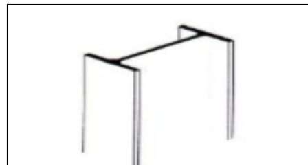
Figure III-45 :Poteau métallique en H - Source :auteurs
