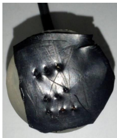
Figure II.4 : Photographie a) d'un échantillon d'acier revêtu avec un polymère b) d'un échantillon d'acier revêtu avec défauts.
