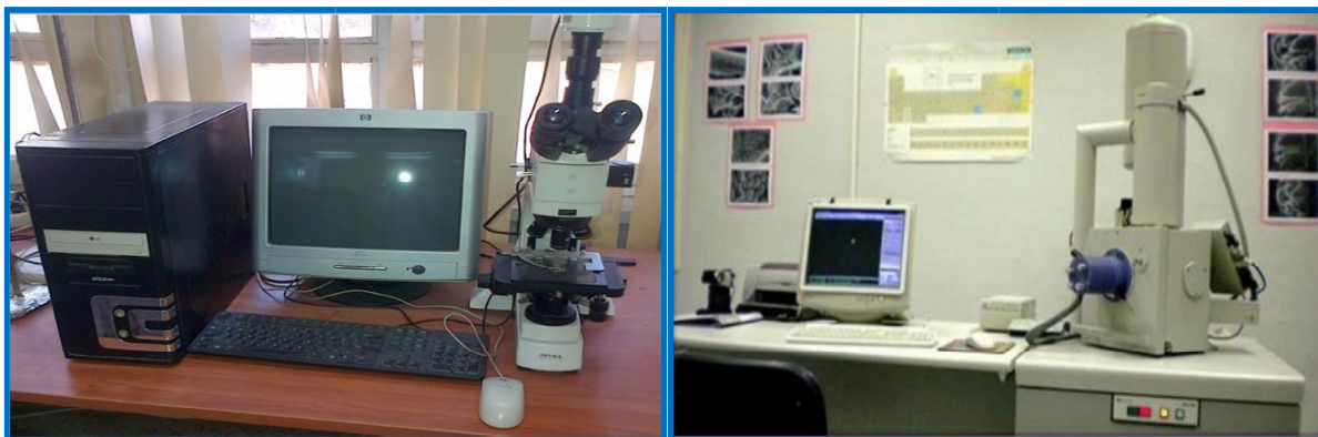
Figure II.10: Image du a) microscope optique b) microscope électronique à balayage.
