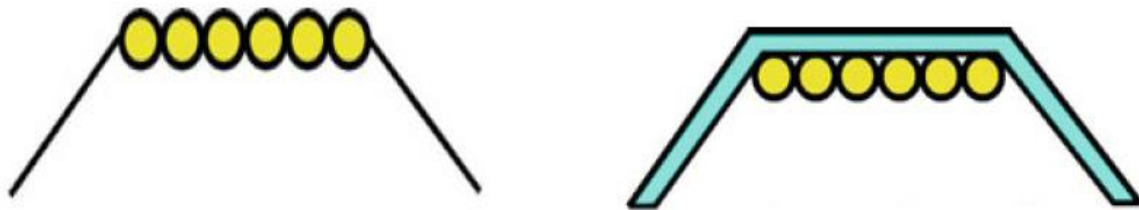
Figure 44: Récepteur multitube avec une cavité trapézoïdale [3]
