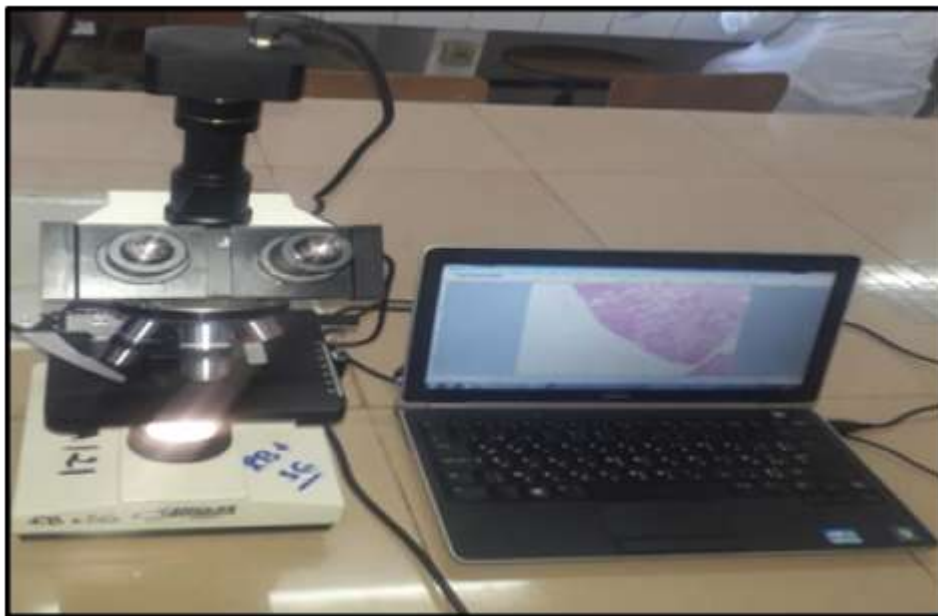
Figure22 : Microscope optique muni d'une caméra liée à un ordinateur (Photo prise en 2023)
