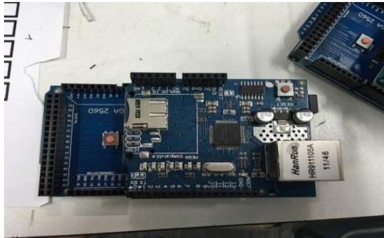
Figure II.9: Ethernet Shield montée sur une carte Arduino Due
