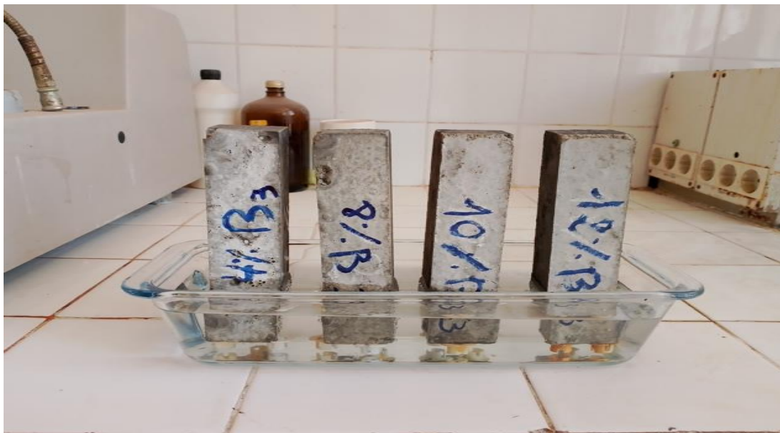
Figure III.10. Essai d'absorption par capillarité des composites Bois-Ciment
