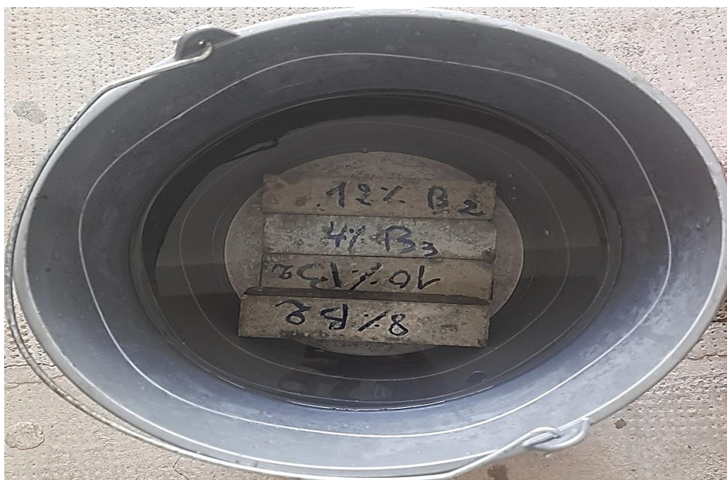
Figure III.11. Essai d'absorption par immersion totale après (24h) dans l'eau des composites Bois-Ciment
