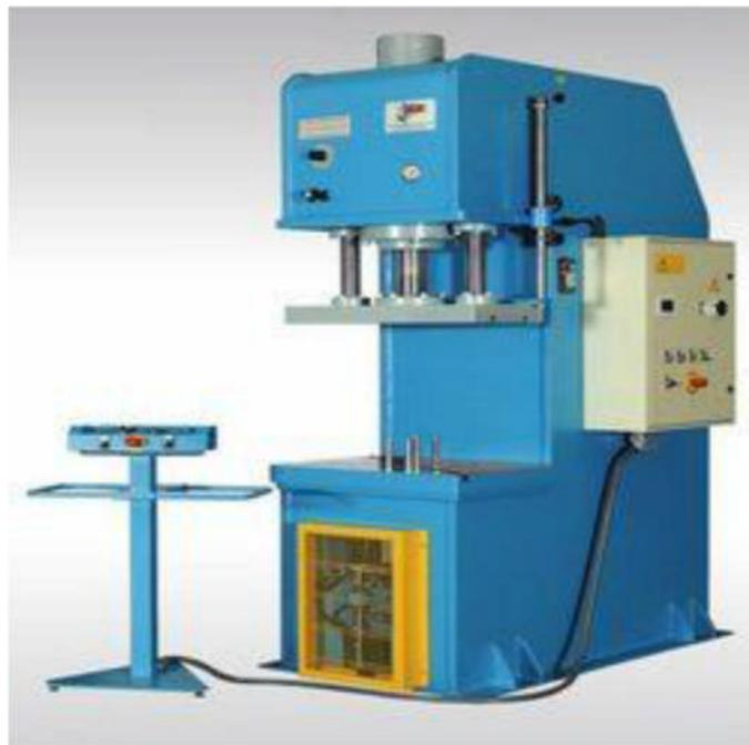
**Fig.II.2 :** Presse hydraulique
