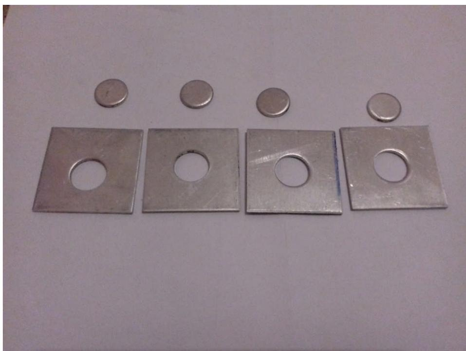
**Fig.IV.12** : Résultat des essais après poinçonnage.
