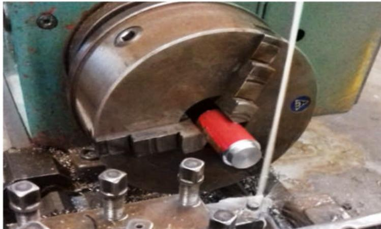
**Figure.III.22 :** Montage en l'air.
