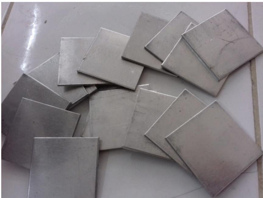
**Fig.V.11** : Les éprouvettes avant le poinçonnage
