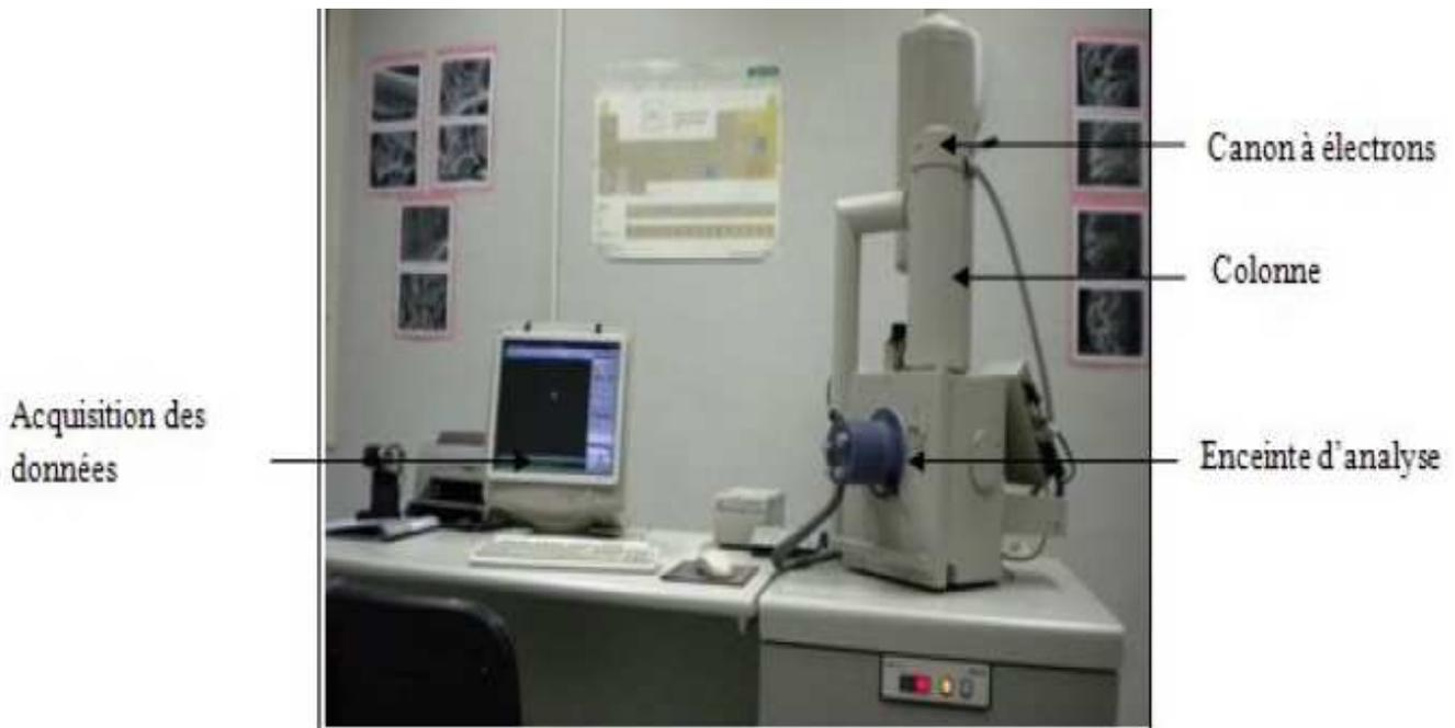
Figure 24 : microscope électronique à balayage utilisé
