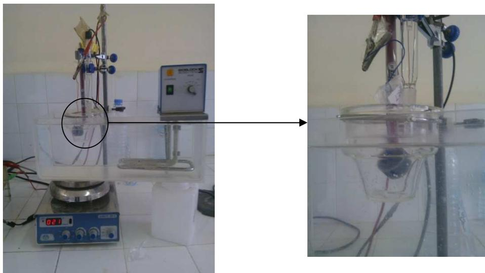
Figure 28 : Cellule électrochimique à trois électrodes de marque AGIMATIC REV-E
