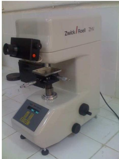
*Figure 25 : Duromètre ZWICK/ROELL*
