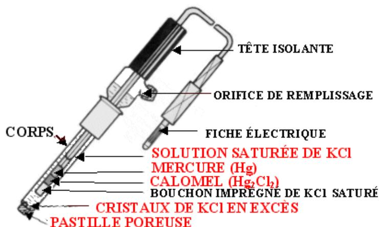
Figure 29 : Electrode au calomel saturé
