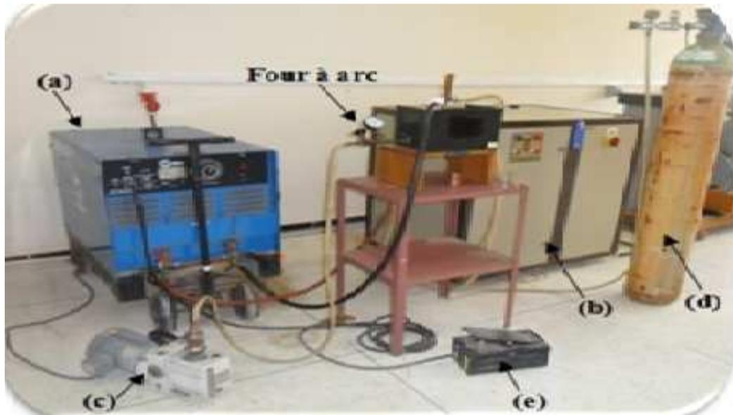
Figure 15 : Four à arc utilisé
