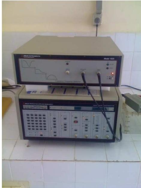
*Figure 30 : Potentiostat Galvanostat utilisé de marque EG&G INSTRUMENTS*
