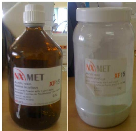
Figure 18 : Résine utilisée pour l'enrobage
