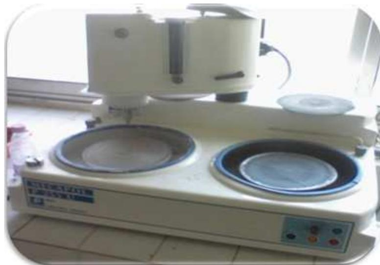
Figure 20 : Polisseuse utilisée de marque MECAPOL
