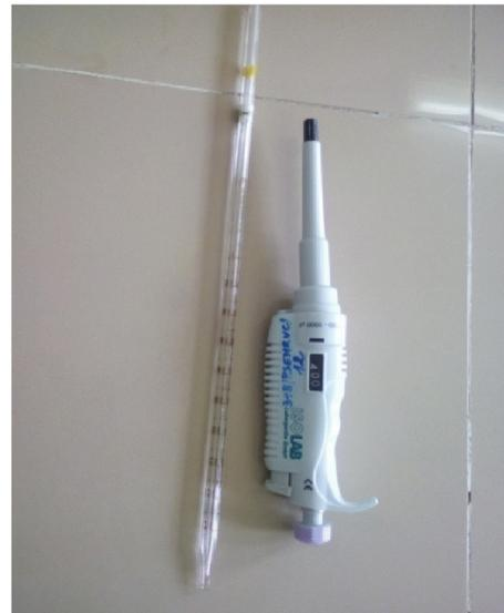
**pipette et micropipette**
