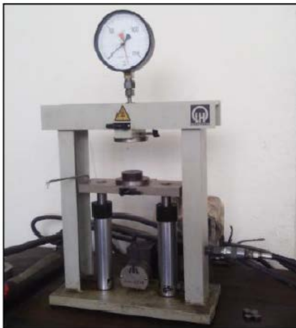
Figure.III.7 : Photographie de la presse hydraulique utilisée pour la compaction des échantillons.
