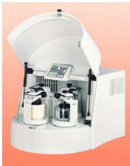
Figure. III.4 : Broyeur planétaire de type MiniMill2.
