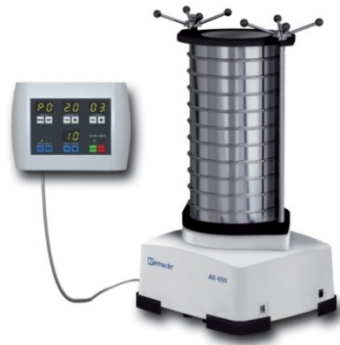
Figure I.3 : Dispositif de tamisage des poudres métalliques.
