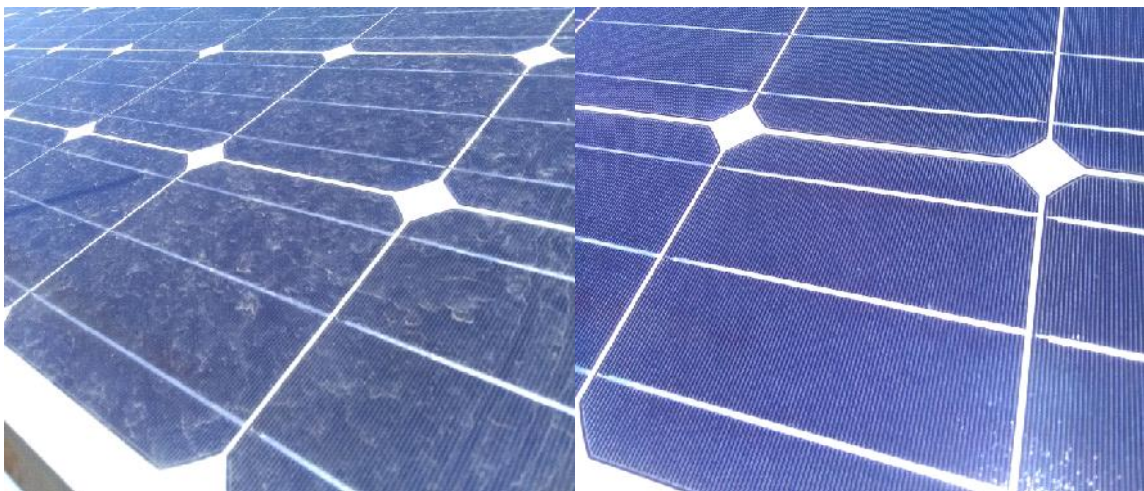
Figure 4.10 Photo du module avec et sans salissure
