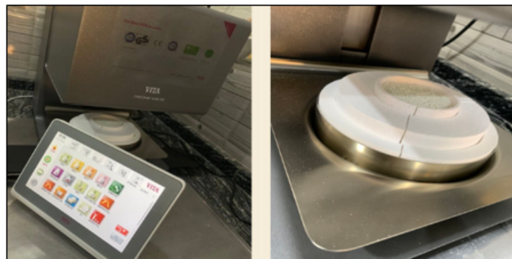
Figure V.33 : Four de frittage VITA ZYRCOMAT 6100 MS
