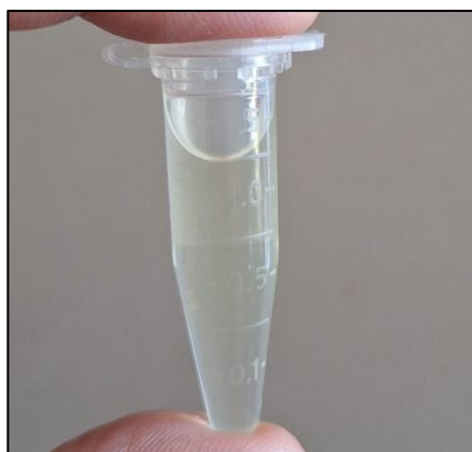
Figure 34. L'huile essentielle extraite des parties aériennes de P. lentiscus par hydro-distillation (Originale, 2025).
