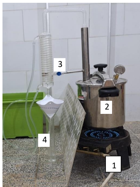
Figure 21. Dispositif d'extraction par hydro-distillation (Originale, 2025)
