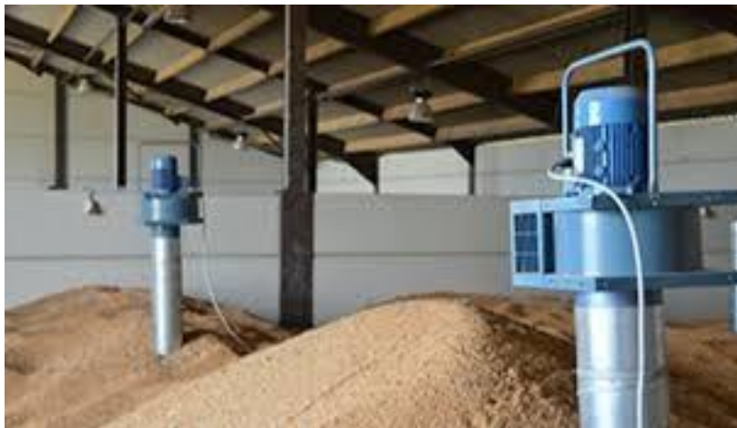
Figure 11. Dispositif de ventilation (Anonyme, 2021)
