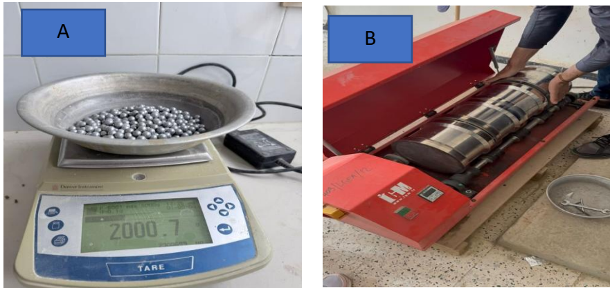
Figure 44 : image montre le poids des billes en fer utiliser(a) et l'appareil micro dévale (b)
