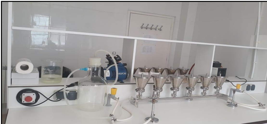
Figure 01: Rampe de filtration sur membrane (ADE, 2021).
