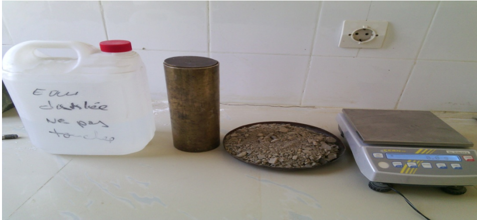
Fig III.2 : Matériel d'essai du pycnomètre en acier.
