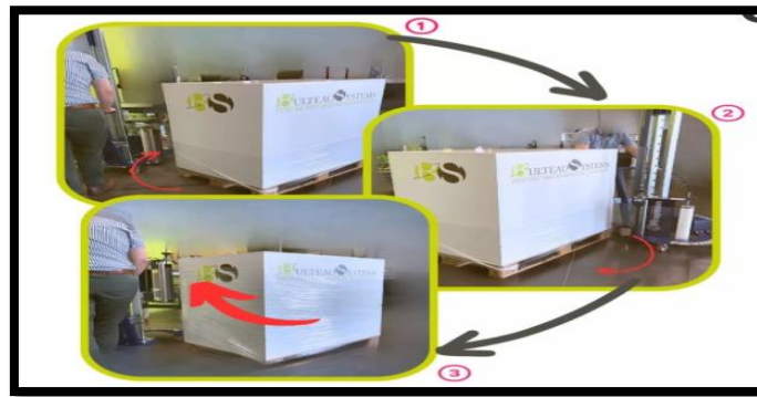
Figure 2.2 : Etapes de fonctionnement de la banderoleuse semi-automatique
