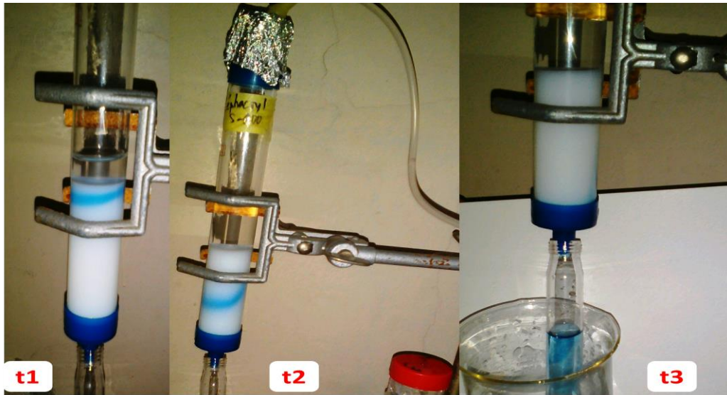
Photo montrant l'éluion du Bleu de Dextran sur la colonne de chromatographie sur Séphacryl S-200 pour mesurer le volume mort ( V_0 )
