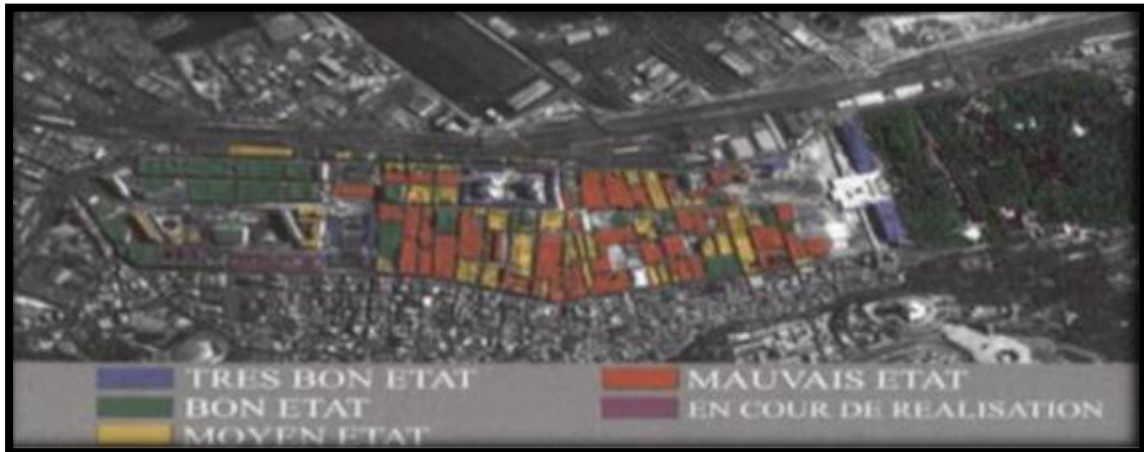
Figure 66 : Etat du bâti au Hamma Source : Google earth /traitement auteurs.
