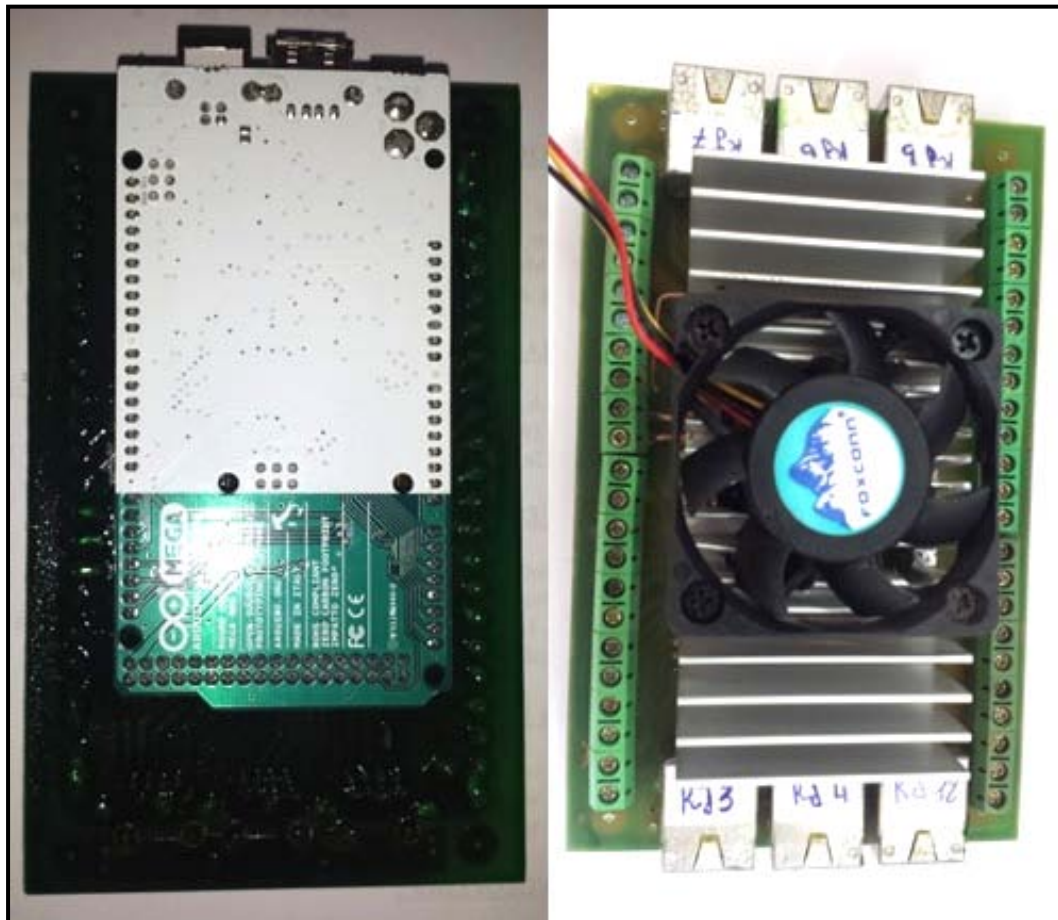
Figure IV.12 : Photo de la carte de la CPU
