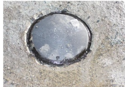
FIGURE 3.2 – Capteur enterré dans le sol [59]
