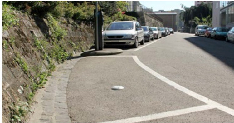
FIGURE 3.3 – Capteur apparent installé sur le sol (28mm de hauteur et 190mm de diamètre) [64]
