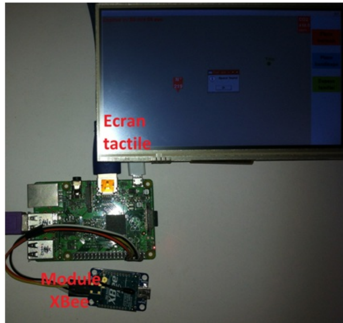
FIGURE 4.2 – Montage embarqué dans le véhicule
