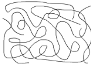
Figure I.7 : Structure amorphe d'un polymère
