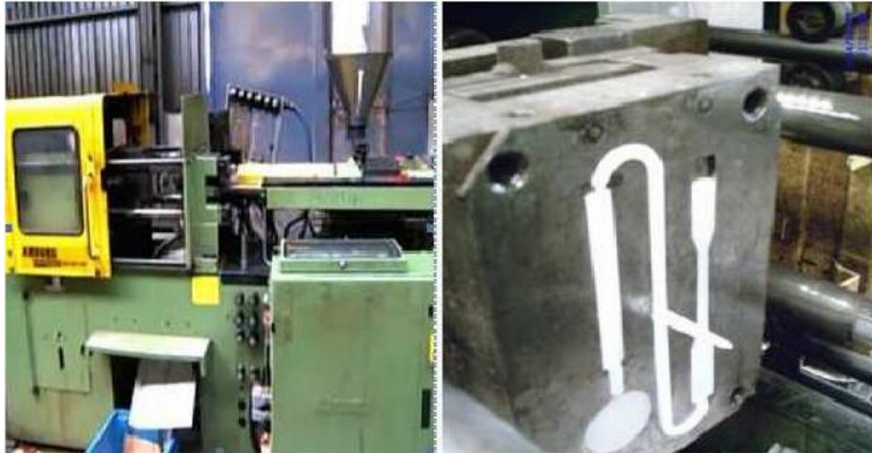
Figure IV.1 Machine à injection et moule éprouvette
