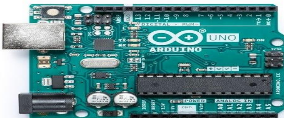
Figure II.3 : Carte Arduino UNO.
