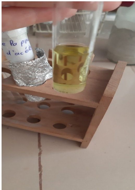
Figure21 :L'obtention d'un extrait lichénique avec de l'acétone
