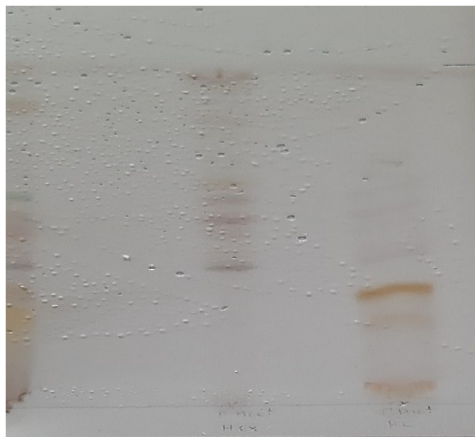
Figure32 : profil chromatographique en phase mobile (135ml de toluène+20ml d'acide acétique)
