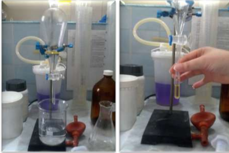
Figure 10: Séparation des H.es par décantation
