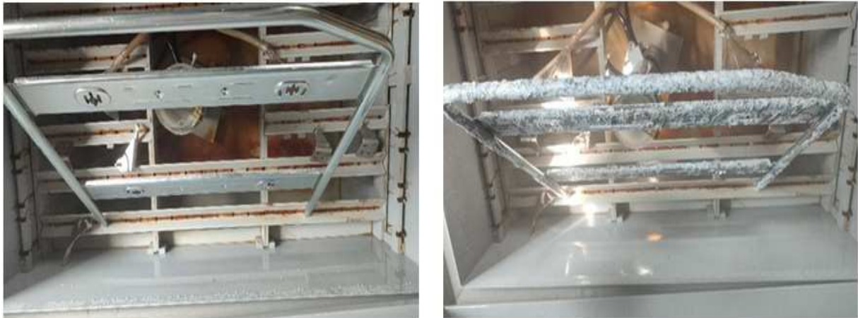
FIGURE II.3 : Apparition de la rouille blanche après 24 heures sur une pièce zinguée
