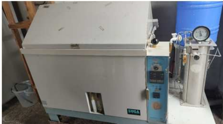
FIGURE II.2 : Dispositif de brouillard salin
