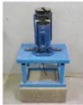
Figure II.3 : Dispositif de l'essai de mesure de la compacité (El Barrak,(2005)).
