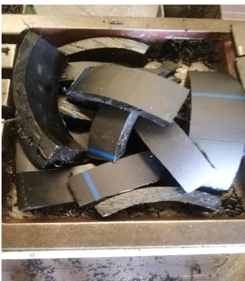
Figure III-2 : échantillons de PEHD découpés à l'aide d'une tronçonneuse.
