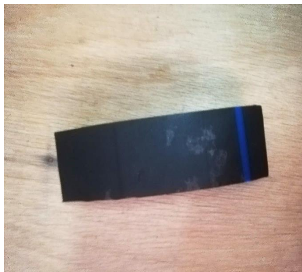
Figure III-2 : échantillons de PEHD découpés à l'aide d'une tronçonneuse.
