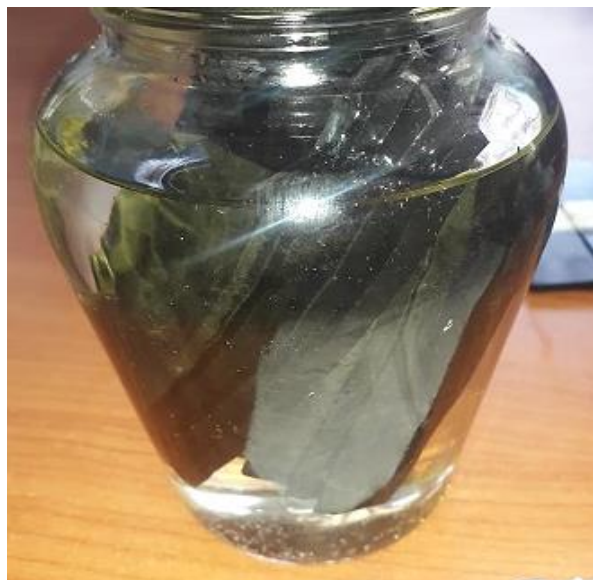
Figure III-4 : éprouvettes en PEHD dans un bain de chlore.
