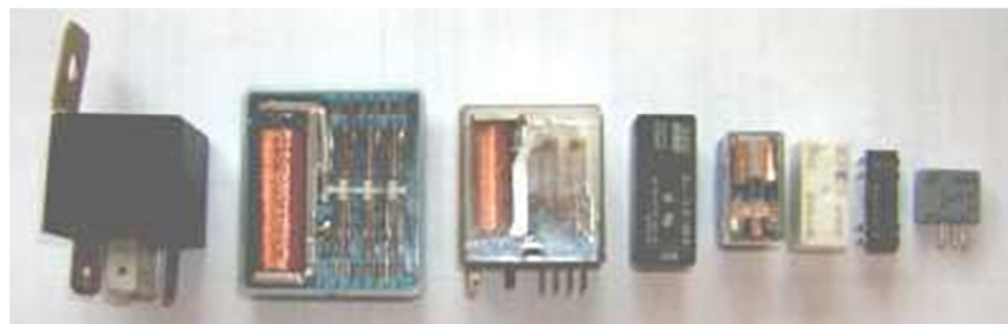
Vue II.4 : les relais mécaniques
