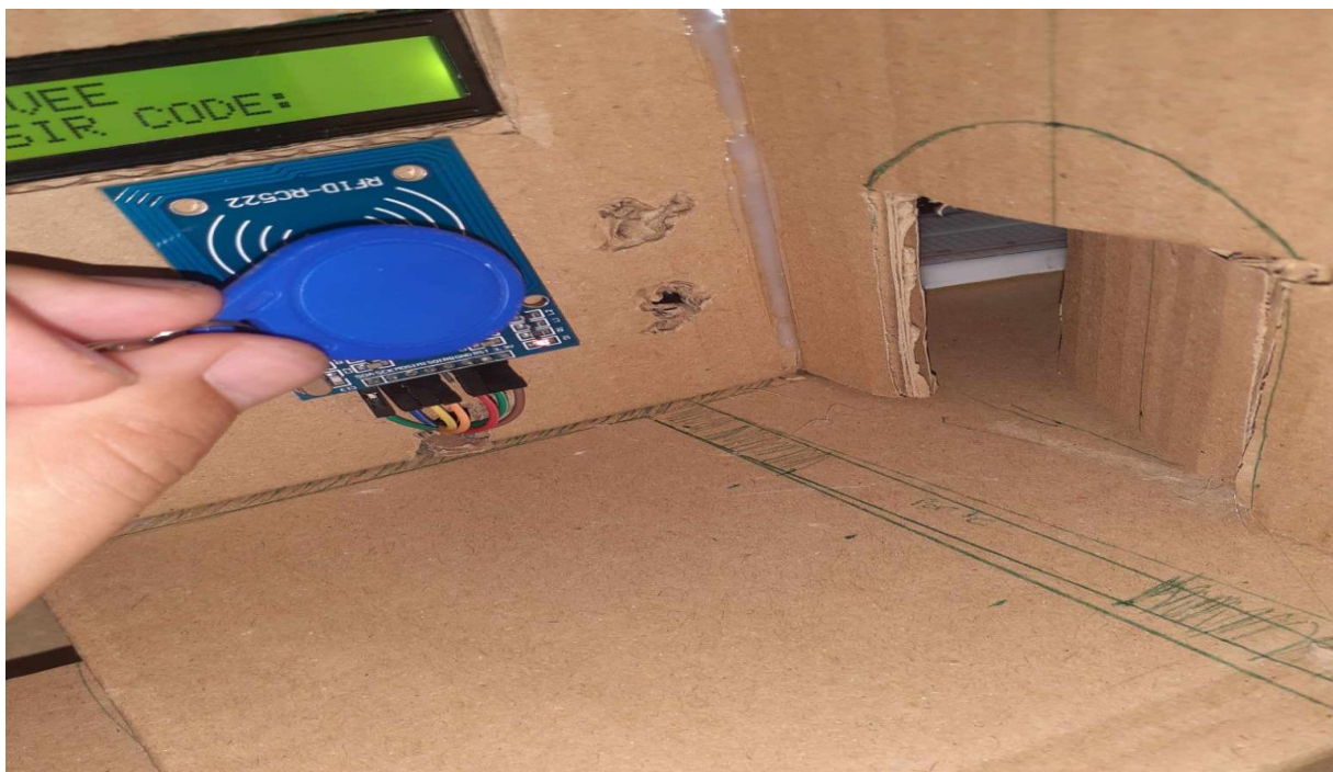
Figure IV.6 : Accès autorise avec le vrai badge et l'ouverture de la porte
