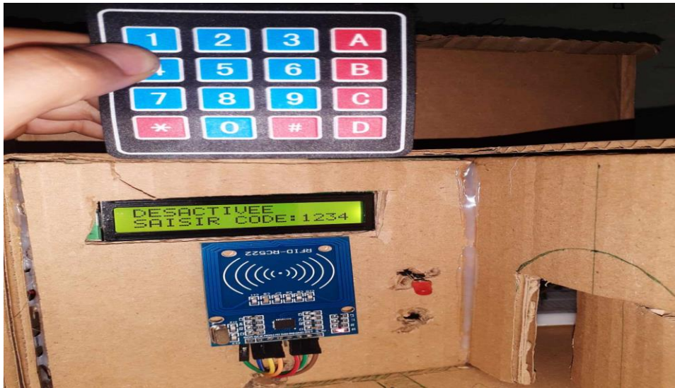
Figure IV.2 : activation d'alarme avec le code « 1234 »
