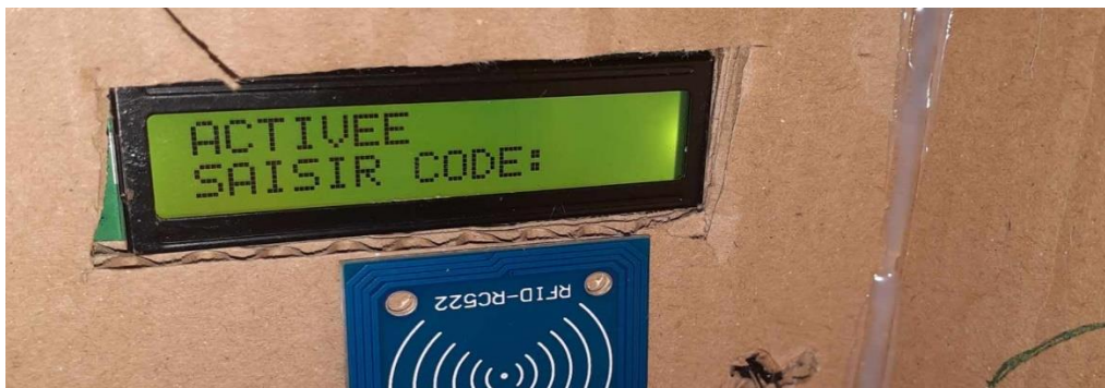
Figure IV.3 : Réussite d'activation affiché sur LCD
