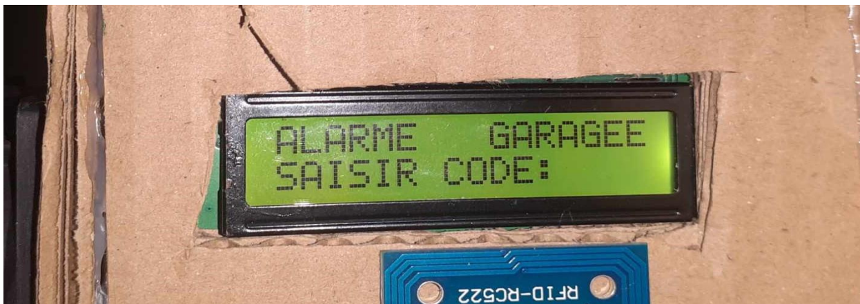
Figure IV.13 : représente l'affichage d'alarme sur le LCD
