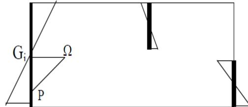
**Figure I.40 :** Contrainte de torsion fléchie.
