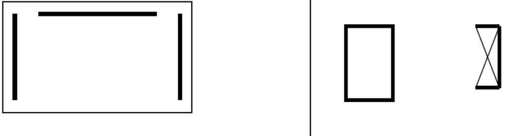
***Figure I.32: Voiles intérieurs cage d'escalier, d'ascenseur, noyau central.***
