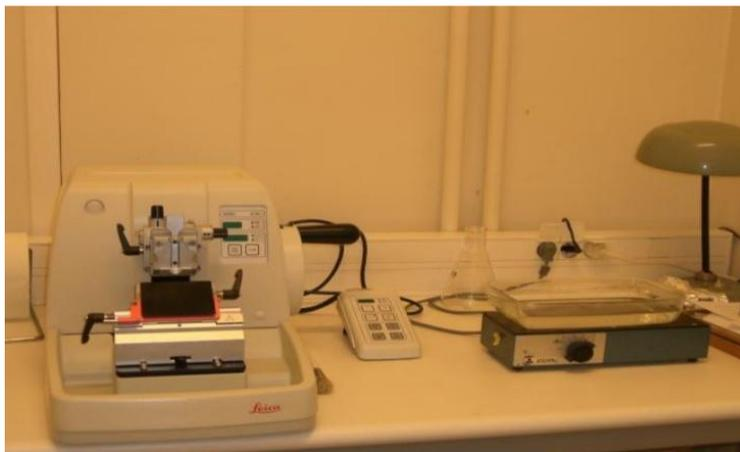
**Figure37** : Microtome à paraffine de type Leica
